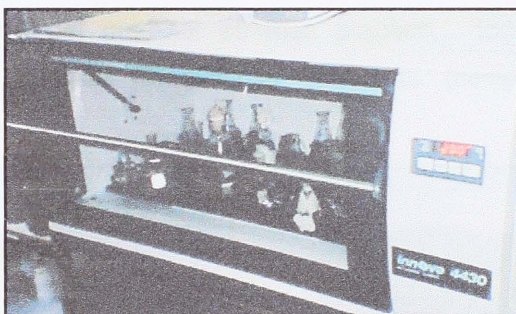
Figura. 3.9. Agitador continuo con temperatura controlada de 35°C/200 RPM (Shaker) para el lixiviado de los materiales.
