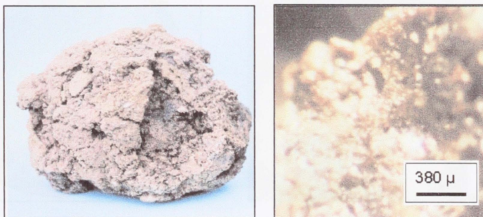
Figura. 3.15. Roca fosfórica tratada a 1000^{\circ}\text{C} con su microestructura
