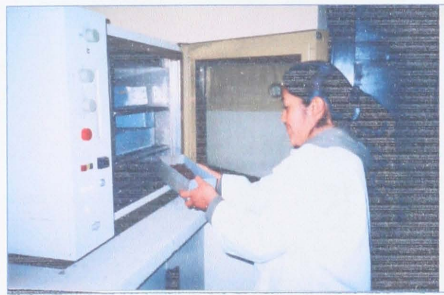
Foto 20: Secado de las muestras en el horno
